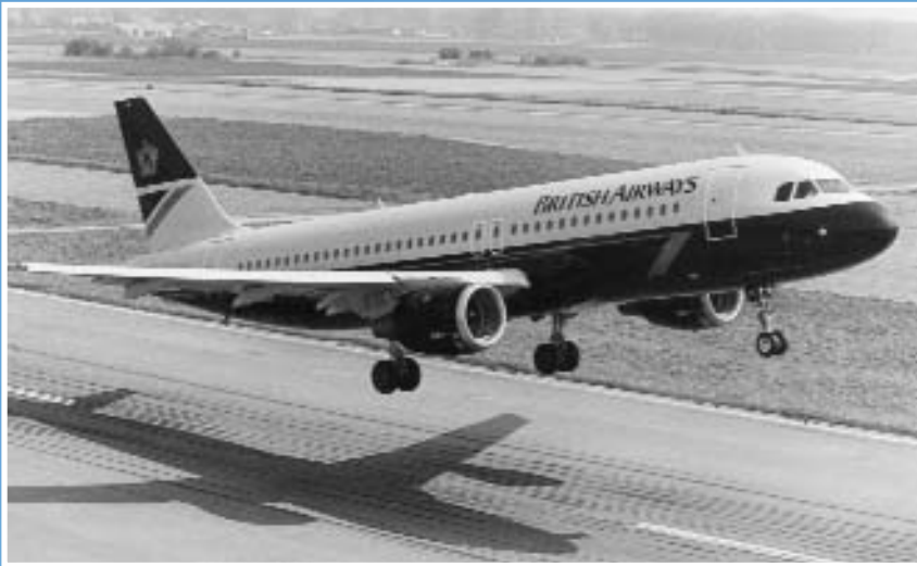
El A320 primer avión comercial en usar el sistema de control automático "flyby-wire"
